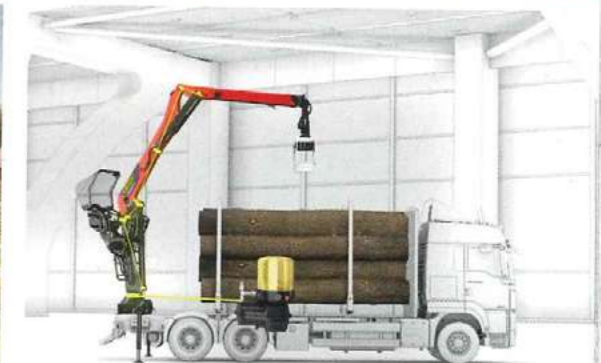
Le système de graissage centralisé simplifie l'entretien et améliore la fiabilité des nouvelles grues.
