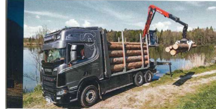
Les capacités de levage des grues Z et L Génération 3 affichent des capacités de levage comprises entre 10 et 18 tonnes métriques.
