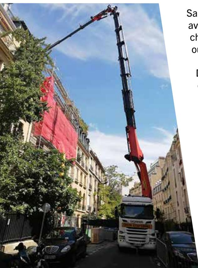
Sa très longue portée (plus de 25 m, et jusqu'à presque 49m avec son fly jib) lui permet de livrer au millimètre près des charges lourdes, directement sur une terrasse ou à travers une ouverture de fenêtre jusqu'au neuvième ou dixième étage.
