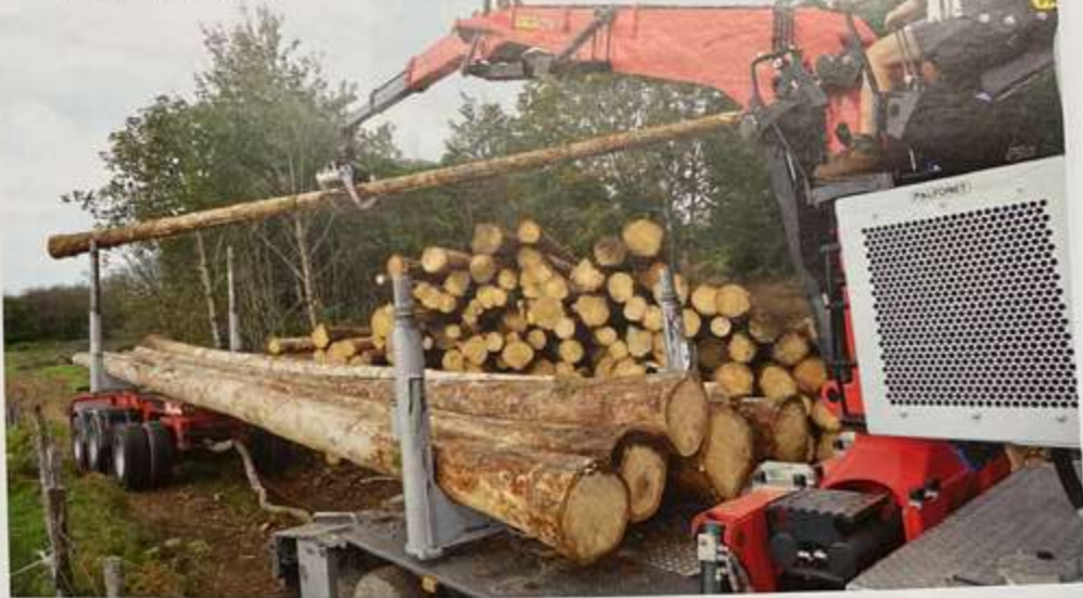
Les extensions du double-télescope se déploient simultanément
