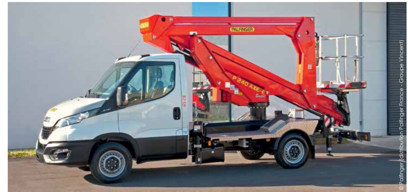
La nacelle P240AXE-E de Palfinger dispose d'une flèche à double articulation, indispensable pour réaliser des interventions complexes. Sa hauteur de travail maximum est de presque 23 m et son déport va jusqu'à plus de 11,5 m.
