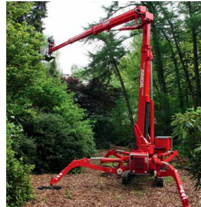
Conçue par le fabricant Teupen, la nacelle LEO21GT peut travailler en hauteur jusqu'à 21 m (12 m en déport avec 250 kg de charge). Elle se distingue par un point d'articulation assez haut (9,44 m). Des capteurs, présents sur les 4 patins de stabilisation, donnent l'alerte sur un écran d'affichage quand la pression au sol est insuffisante.
